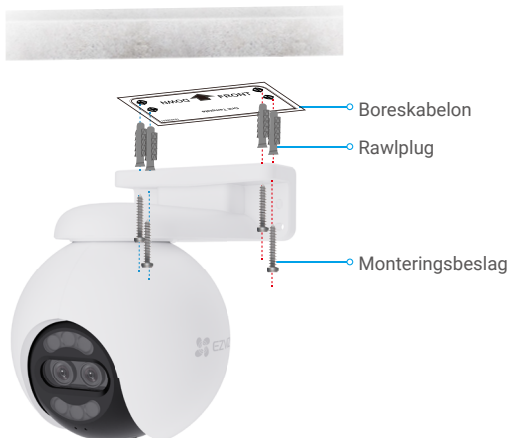
Fig. 1 Montering i loft
